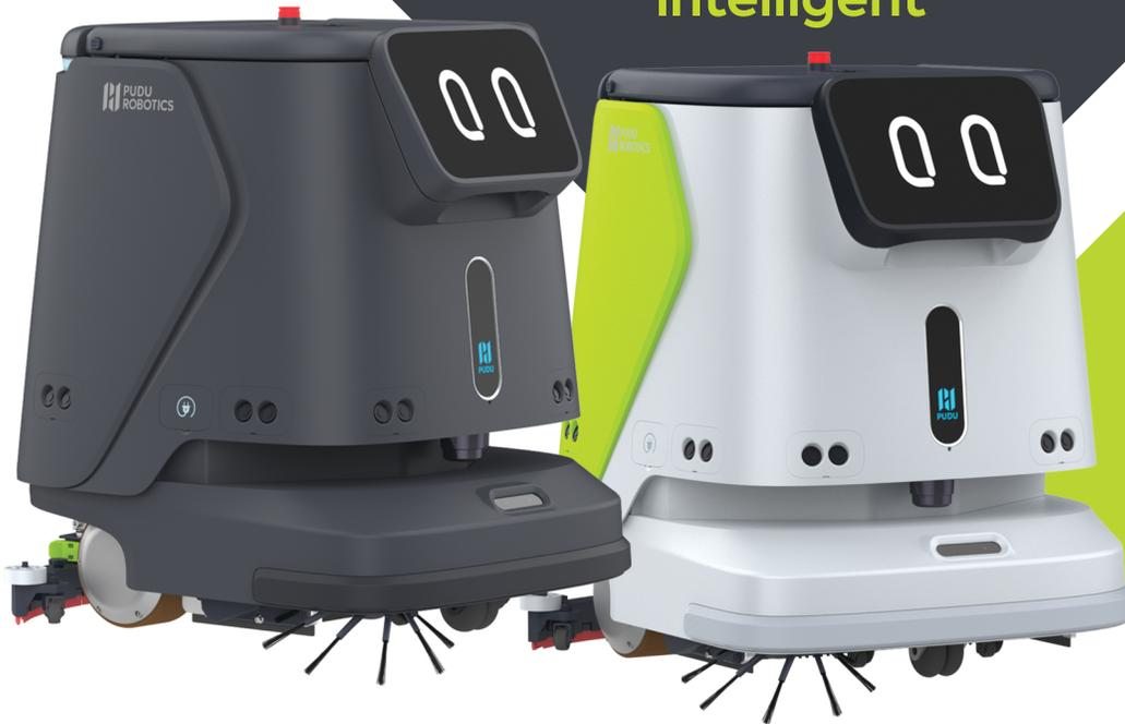
**BALAYAGE, RÉCURAGE, ASPIRATION ET LAVAGE : QUATRE FONCTIONS EN UN SEUL APPAREIL.**
